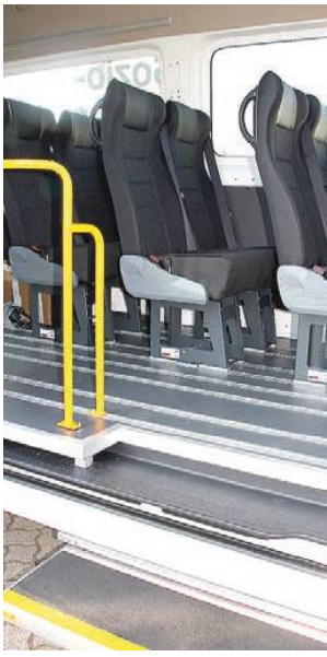
Die Stufe fährt automatisch raus damit Fahrgäste bequem, ins Sozio-Med-
